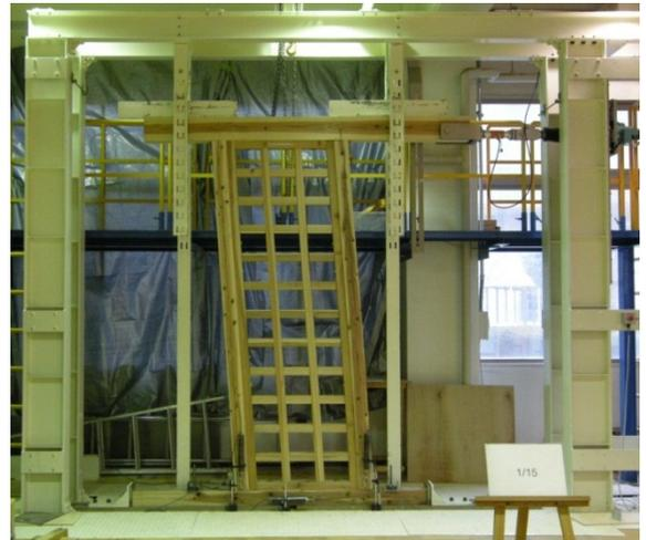
写真1 面格子壁の実験の様子
